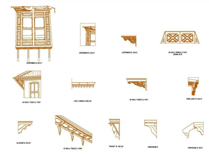
Şekil 5. Cephe Çıkma ve Saçak Detayları (Akşehir Kentsel Tasarım Rehberi, 2009)
